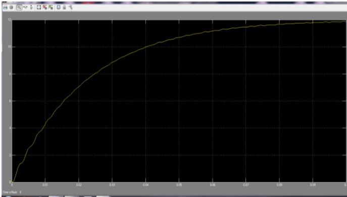
Рис. 5. Осциллограмма выходного напряжения чоппера
